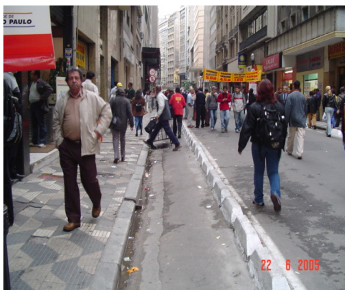
Fotos 84 e 85: Prismas de concreto utilizados como delimitação da ampliação de calçada: Na fase de obras a desconsideração das características do modo de transporte a pé trouxe resultados inadequados. – Rua 7 de Abril Fotos da autora
