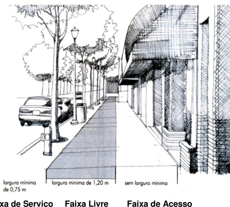
Figura 8: Calçada Padrão do Programa Passeio Livre – Perspectiva (77)
