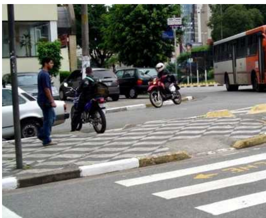
Fotos 182 e 183: Manobra proibida da moto aproveitando o rebaixo de calçada em travessia e extensão total do rebaixamento da calçada em posto de gasolina possibilita o acesso veicular em qualquer ponto da calçada.
