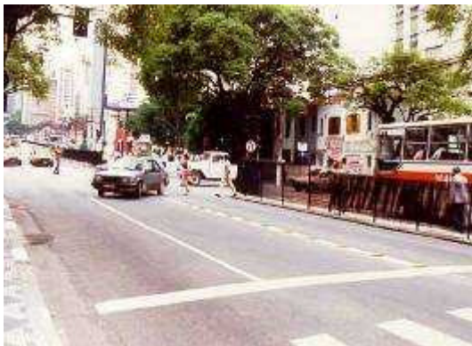
Fotos 192 e 193: Dois exemplos de tentativas não bem sucedidas para deslocar a travessia do pedestre através de gradil de corrente - Sub-centro de Itaquera e gradil metálico - Av. 9 de Julho
