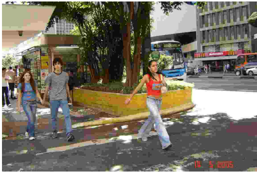
Fotos 212 e 213: Vegetação arbustiva junto às esquinas comprometendo a intervisibilidade entre pedestre e motorista – Av. Paulista
