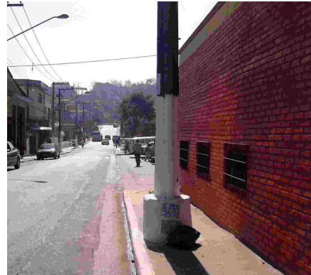
Fotos 220 e 221: Duas situações onde a posição do poste de iluminação compromete a área de circulação a pé – Sub-Centro de Guaianases e Av. São Gabriel.
