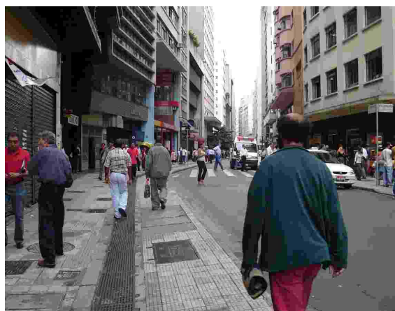
Foto 86 e 87: A ampliação da calçada melhorou as condições da caminhada, apesar da declividade transversal estar fora de norma, ocasionando desconforto e comprometendo a qualidade da intervenção. Rua 7 de Abril Fotos da autora
