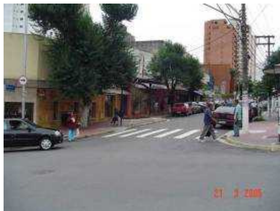
Fotos 151 e 152: Faixas de travessia não semaforizadas situadas em esquinas – na seqüência da calçada – Faixas Zebradas
