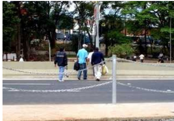
Fotos 192 e 193: Dois exemplos de tentativas não bem sucedidas para deslocar a travessia do pedestre através de gradil de corrente - Sub-centro de Itaquera e gradil metálico - Av. 9 de Julho
