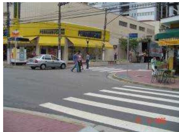
Fotos 156 e 157: Exemplos de situações onde a travessia foi recuada da linha de desejo do pedestre para ficar alinhada ao rebaixamento de calçada – Ruas Joaquim Nabuco e Princesa Isabel
