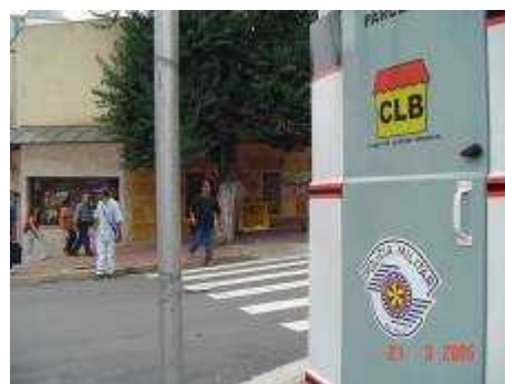
Foto 147 foto 148: Cabine da Polícia Militar ou elemento paisagístico comprometem a visibilidade do local de espera / chegada da travessia
