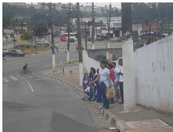
Fotos 80 e 81: Situações de a calçada insuficiente para acomodar pedestres junto aos pontos de ônibus – R. Benjamin Constant (Centro) e Av. dos Têxteis (Sub-Centro de Cidade Tiradentes), obrigam os usuários invadir a rua em situação de risco. As infraestruturas relativas ao transporte coletivo tem que atender principalmente seu principal cliente: o pedestre.
