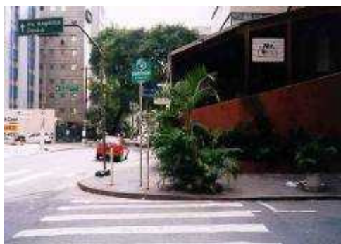
Foto 147 foto 148: Cabine da Polícia Militar ou elemento paisagístico comprometem a visibilidade do local de espera / chegada da travessia
