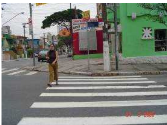
Fotos 151 e 152: Faixas de travessia não semaforizadas situadas em esquinas – na seqüência da calçada – Faixas Zebradas
