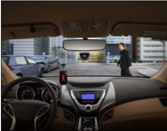
Figura 3: sistema de detecção de pedestres (V2P)
