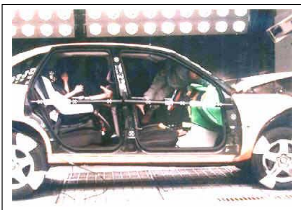
Foto 2: Crash test – GMB. Mostra o boneco preso ao assento infantil e o outro sendo atirado contra o painel e o pára-brisa, instantes após o impacto frontal.
