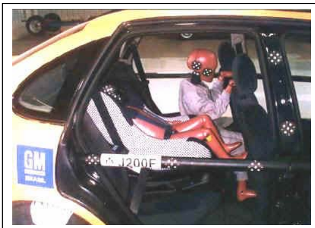
Foto 1: Crash test – GMB. Mostra um boneco preso ao assento infantil e o outro sentado junto aos bancos dianteiros, onde geralmente viajam crianças entre 4 e 8 anos
