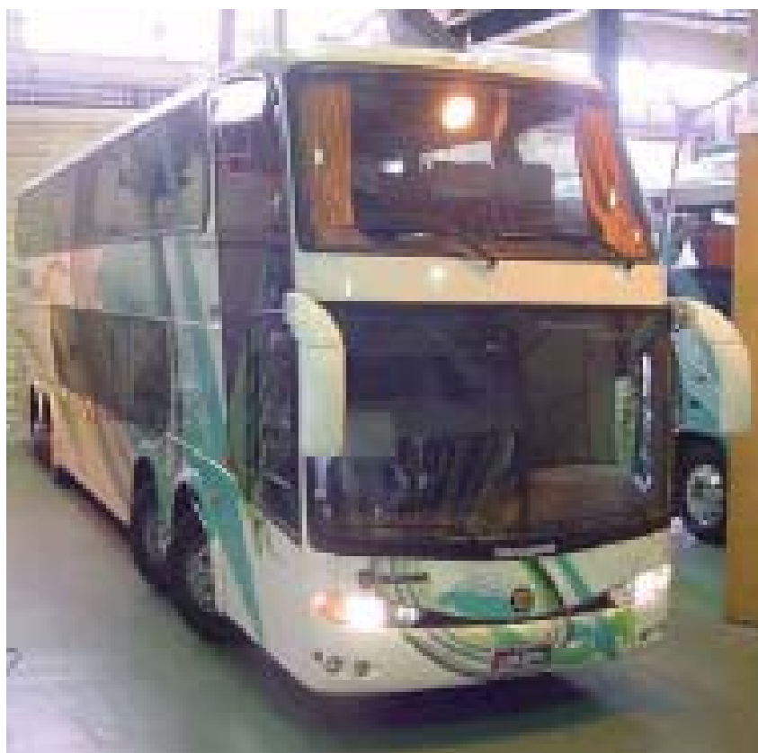
FIGURA 35 - Ônibus Scania K124 IB 8X2 NB 420 com carroçaria Marcopolo Paradiso 1800DD
