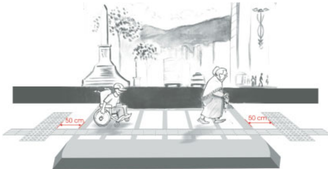
Figura 31 - Faixa Elevada Sinalizada
