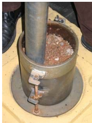
Figura 9: Compactação do corpo-de-prova para o ensaio de ISC
