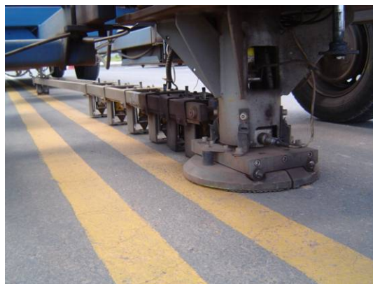
Figura 14: Detalhe da aplicação da carga e sensores
