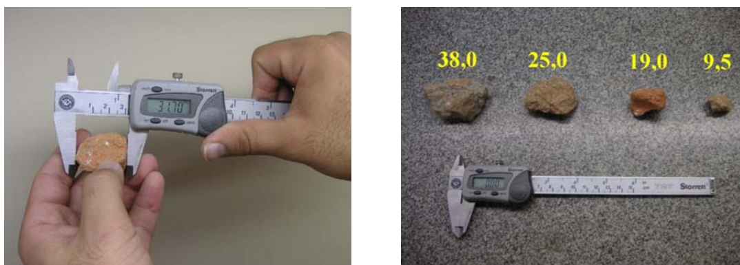
Figura 7: Medição com paquímetro digital e exemplos de frações do agregado reciclado
