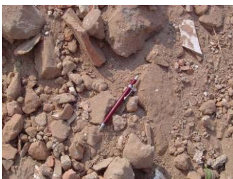
Figura 4: Agregado reciclado utilizado na base do pavimento da USP-Leste
