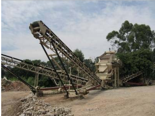
Figura 1: Vista do peneirador mecânico da usina recicladora da PMSP
