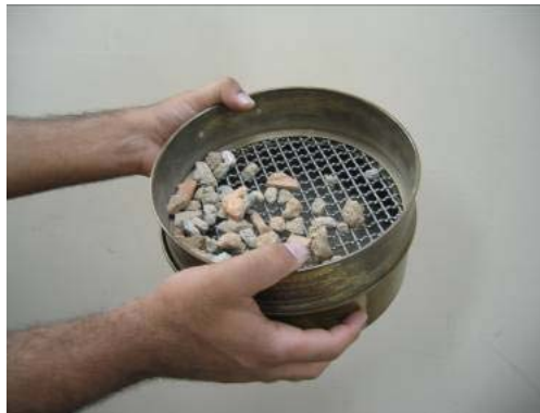
Figura 20: Peneiramento a seco do agregado reciclado
