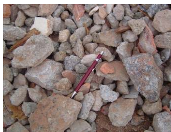
Figura 5: Agregado reciclado utilizado na sub-base do pavimento da USP-Leste
