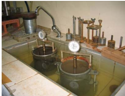
Figura 11: Corpos-de-prova de ISC imersos em água destilada
