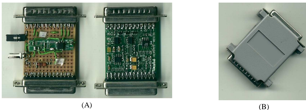
Figura 4-9: Parametrizador. (A) Placa em estágio inicial de desenvolvimento e placa final montada. (B) Caixa fechada.
