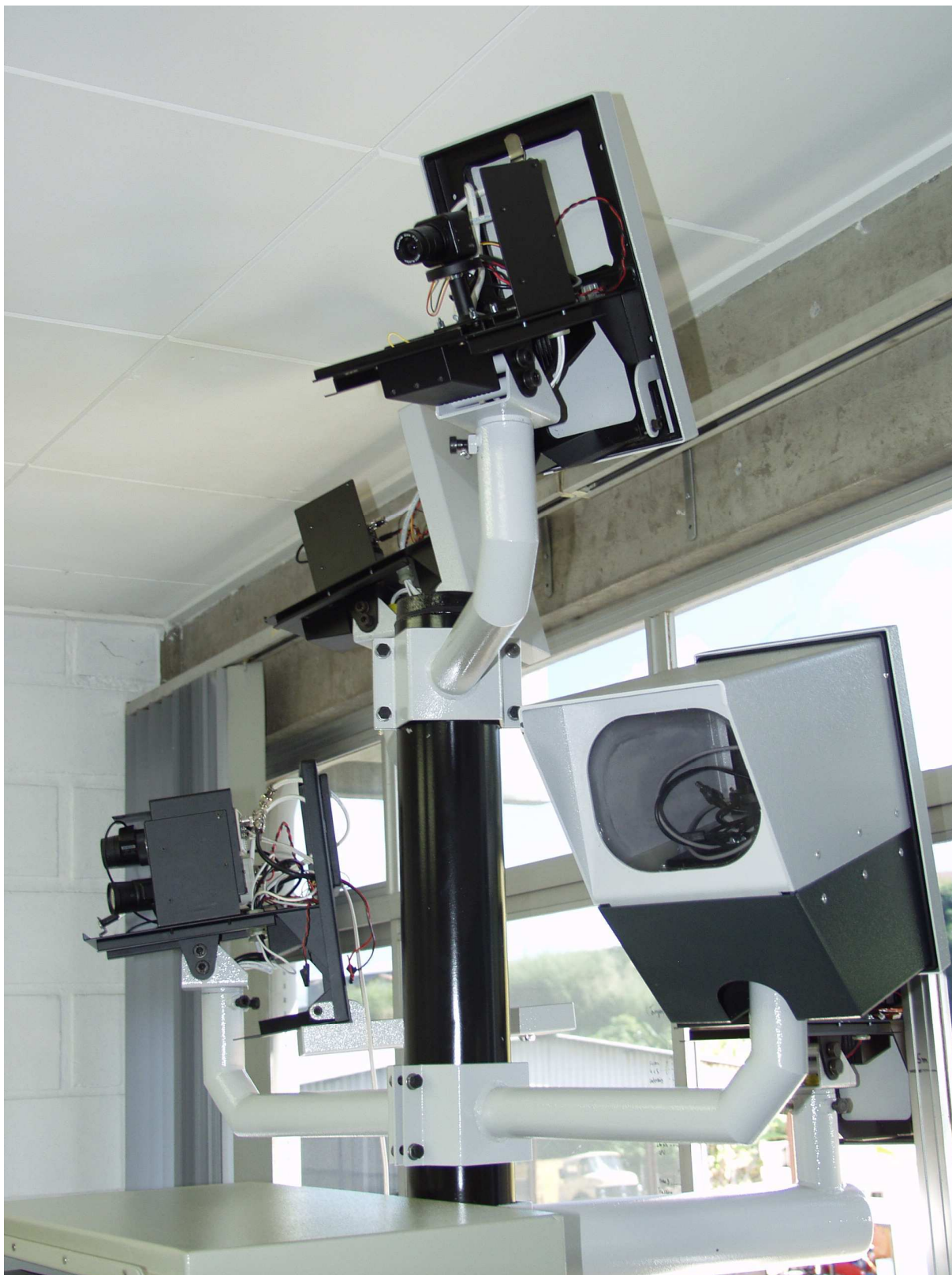
Figura 4-8: Detalhe da parte superior da mini-estrutura mostrando braços de sustentação e caixas de câmera aberta e fechada.
