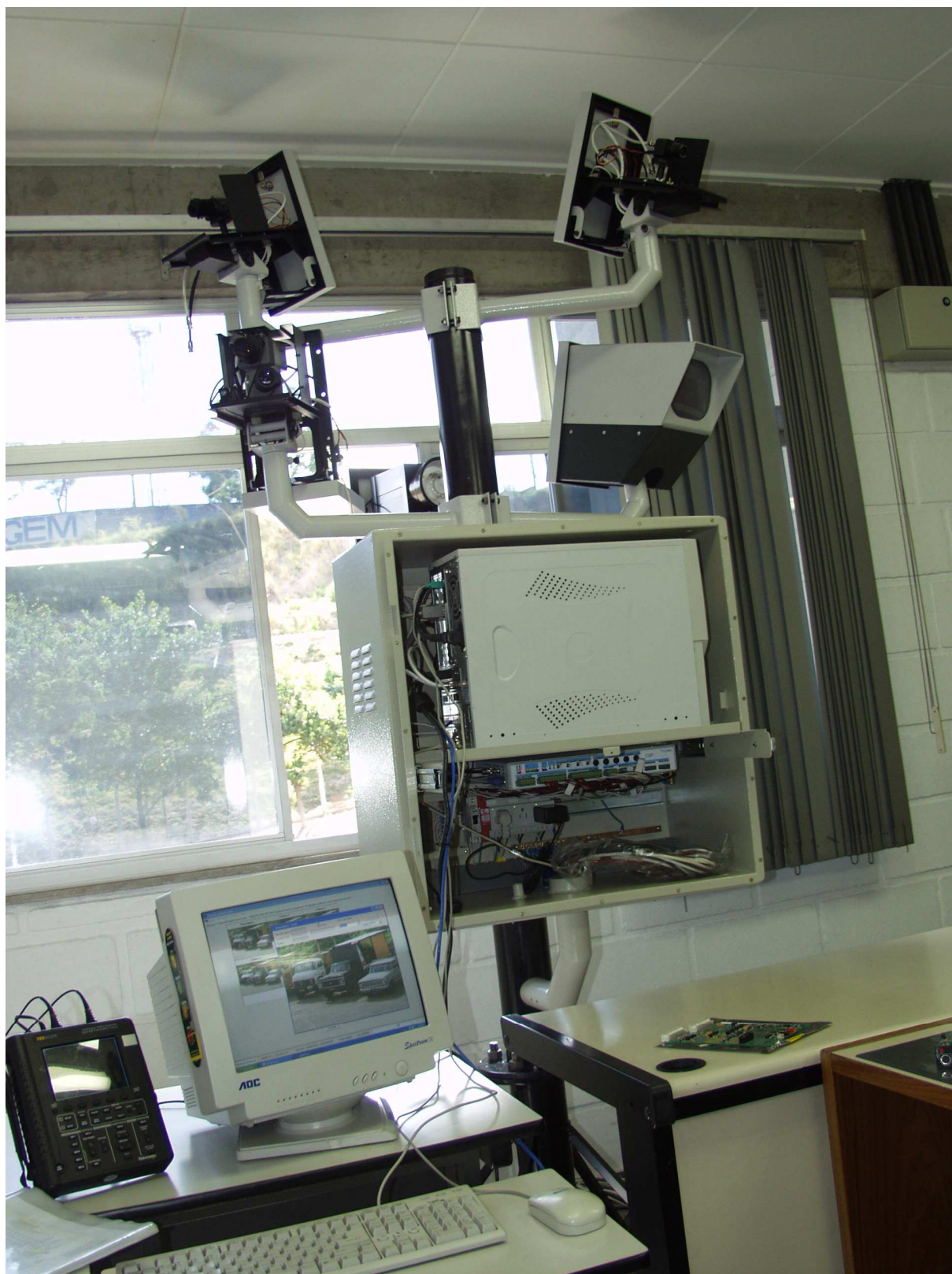
Figura 4-6: Visão geral do protótipo de registro de veículos mostrando a mini-estrutura de desenvolvimento, caixa da CPU e das câmeras/flash (com uma das caixas de câmera fechada) e interface homem-máquina (software) para ajuste de câmeras no monitor.
