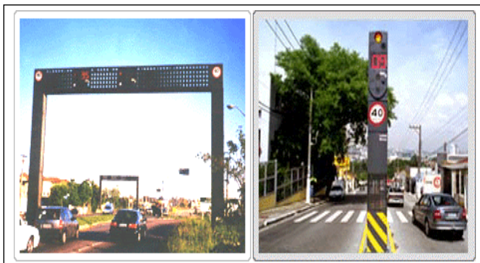
Figura 3.3 – Fotos de lombada eletrônica em pórtico e em totem.
