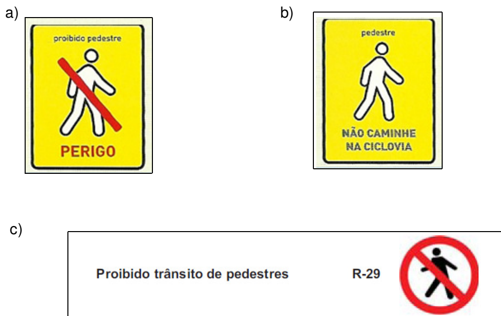
Figura 36: (a) e (b) Placas de Sinalização no Rio de Janeiro. Fonte: Ciclovias Cariocas, 2005, p.170; (c) Sinal de Regulamentação do CONTRAN. Fonte: Volume I - Sinalização Vertical de Regulamentação, 2007c, p.119.
