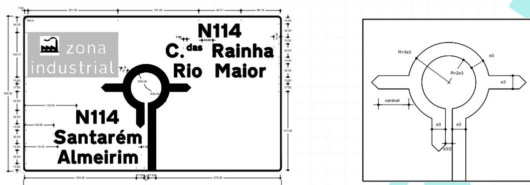
Figura 3. 14 - Dimensionamento do pré-aviso gráfico com inversão de marcha
