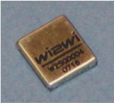
Receptor GPS, Frequência L1, fabricado pela empresa WI2WI. Mede 12 x 12 x 3 mm
