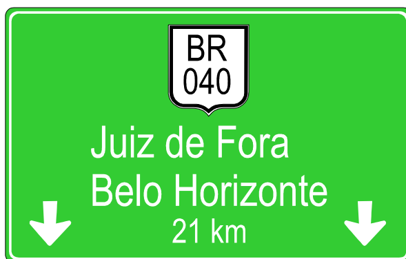
Figura 2.62 - Painel de Pré-indicação de Saída, com seta para baixo
