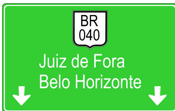
Figura 2.63 - Painel de Indicação de Saída, com seta para baixo
